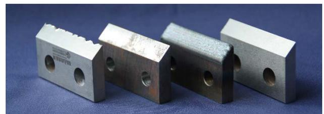
Bild: Reparaturschritte am Beispiel eines Schneidmessers
