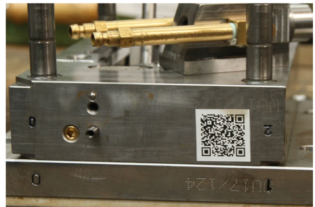
Abb. 2: Spritzgusswerkzeug mit QR-Code
