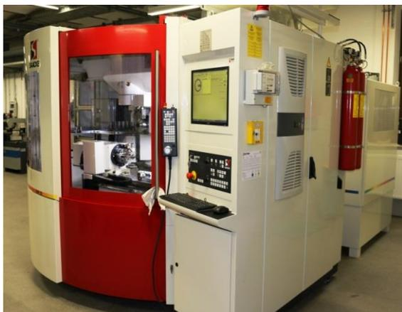
Nach der Auswertung der Sensorsignale erfolgen durch die Übertragung der ausgewerteten Daten über die Schnittstelle der Schleifmaschine die notwendigen Änderungen bzw. Korrekturen der Zustellparameter für den Schleifprozess.
